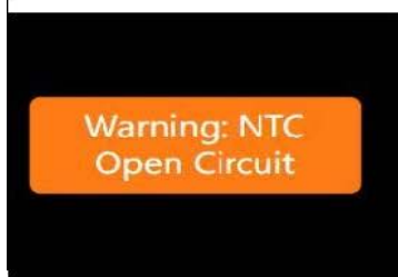
Ostrzeżenie o przerwaniu obwodu w czujniku NTC
