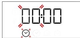
Izmantojiet + vai -, lai iestatītu stundas, un nospiediet , lai apstiprinātu. Displejā mirgos divi cipari, kas apzīmē minūtes. Izmantojiet + vai -, lai iestatītu vēlamās minūtes, un nospiediet , lai apstiprinātu. Lūdzu, nemiet vērā: Ja mirgo ikona, piemēram, pēc
