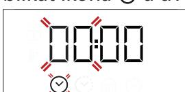
Pro nastavení hodin použijte + nebo - a pro potvrzení stiskněte . Na displeji začnou blikat dvě číslice nastavení minut. Pro nastavení minut použijte + nebo - a pro potvrzení stiskněte .
