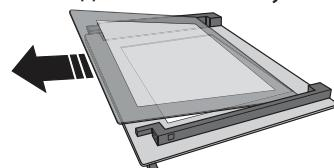
3. Встановіть проміжну панель (позначену «R») перед встановленням внутрішньої панелі: Щоб правильно встановити скляні панелі, переконайтесь, що маркування «R» можна побачити у лівому кутку. Спочатку вставте довгу сторону скла, позначену символом «R», в опорні гнізда, потім опустіть його у відповідне положення. Повторіть цю процедуру для обох скляних панелей.
