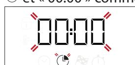
Utilisez + ou - pour régler le temps de cuisson souhaité, puis appuyez sur pour confirmer. Activez la fonction en tournant le bouton du thermostat à la température désirée : un signal sonore retentit et l'écran indique que la cuisson est terminée.
