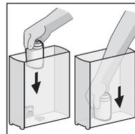
Plaats de waterfilterpatroon aansluitend met de hand (of, indien beschikbaar, met behulp van de maatlepel) in het waterreservoir.
