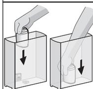
Posizionare il filtro nel serbatoio dell'acqua.
