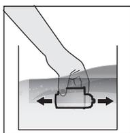
将滤水器滤芯放在凉水中轻轻晃动，以去除所有的气泡。
