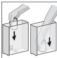
Herefter anbringes vandfilterpatronen med hånden i vandtanken, så den kommer til at sidde godt fast (evt. ved hjælp af pulvereske).
