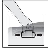
Filtre kartuşunu soğuk suyun içine daldırın ve hava kabarcıklarının tümünü çıkarmak için filtreyi hafifçe hareket ettirin.
