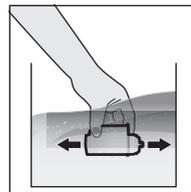
Drücken Sie die Wasserfilterkartusche unter kaltes Wasser und schwenken Sie sie leicht, um alle Luftblasen zu entfernen.
