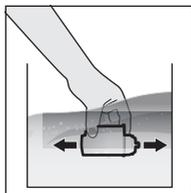
Занурте фільтрувальний картридж для води в холодну воду і трохи погойдайте ним під водою, щоб із нього вийшло все повітря.
