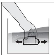
Погрузите картридж фильтра для воды в холодную воду и слегка потрясите его, чтобы удалить все пузырьки воздуха.
