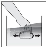
Immerger la cartouche filtrante dans de l'eau froide et la secouer doucement pour évacuer les bulles d'air.
