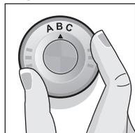
Regolare la ghiera posta sul lato inferiore del filtro per il filtraggio dell'acqua sul livello rilevato.
