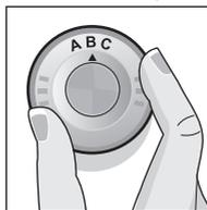
Pierścień na spodzie wkładu filtrującego nastaw na wyznaczoną wartość.
