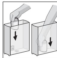
Anschließend setzen Sie die Wasserfilterkartusche mit der Hand (falls vorhanden mit Hilfe des Pulverlöffels) im Wassertank fest auf.
