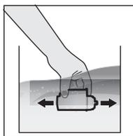
Presione el cartucho filtrante sumergido en agua fría y balancéelo ligeramente para eliminar todas las burbujas de aire.
