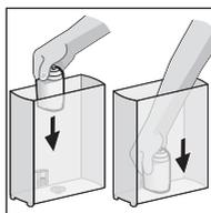
Därefter sätter du fast vattenfilterpatronen med händerna (eller med hjälp av fästet på baksidan av pulverskeden) i vattentanken.
