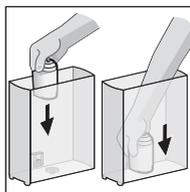
После этого рукой (или с помощью мерной ложки для порошка, если она есть) плотно установите картридж в емкости для воды.
