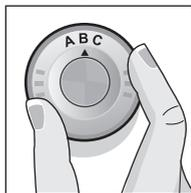
Встановіть кільце регулювання аромату знизу на фільтрувальному картриджі на визначений рівень.
