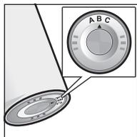
Benyt medfølgende teststrimmel til at bestemme optimal indstilling af aromaringen.
