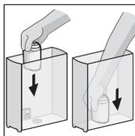
Στη συνέχεια τοποθετήστε τη φύσιγγα φίλτρου νερού με το χέρι στο δοχείο νερού (εάν χρειαστεί χρησιμοποιήστε το κουτάλι σκόνης).
