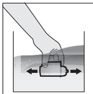
Coloque o cartucho de filtragem de água por baixo de água fria e agite-o levemente para eliminar todas as bolhas de ar.
