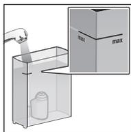
Зніміть резервуар для води і наповніть його холодною водою до позначки «max».
