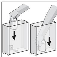
Тоді надійно вставте фільтрувальний картридж для води рукою (або за допомогою ложки для порошку, якщо вона є) в резервуар для води.
