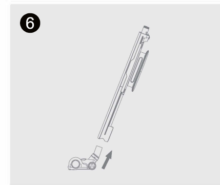
6. Utrzymując szczotkę w jednej linii ze złączeniem rury, włóż ją powoli.
