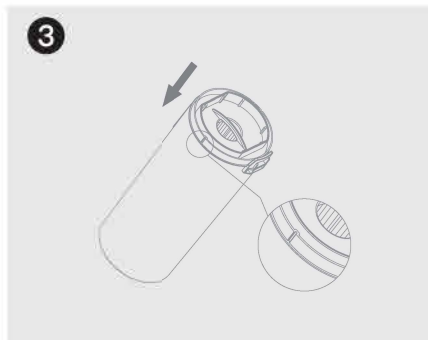
3. Upewnij się, że filtr HEPA i bawełniany filtr są mocno osadzone na miejscu.
