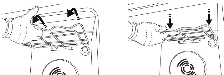
**3.** Aby ponownie umieścić grzałkę na miejscu, należy ją podnieść, lekko pociągnąć do siebie i oprzeć na obsadach bocznych.
