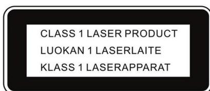
Urządzenie zawiera część laserową (Klasa 1 - lasery które są bezpieczne w racjonalnych warunkach pracy). Etykieta THE CLASS 1 LASER PRODUCT znajduje się z tyłu obudowy.
