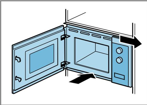
**3. Заворачивайте винты прибора до тех пор, пока он не будет выровнен по центру.**
