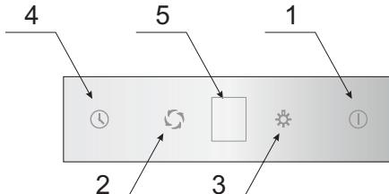
Advertencia: El motor de la campana funciona solamente al sacar el panel frontal. La campana tiene un interruptor extremo, cada introducción del panel frontal ocasiona la desactivación del motor.
