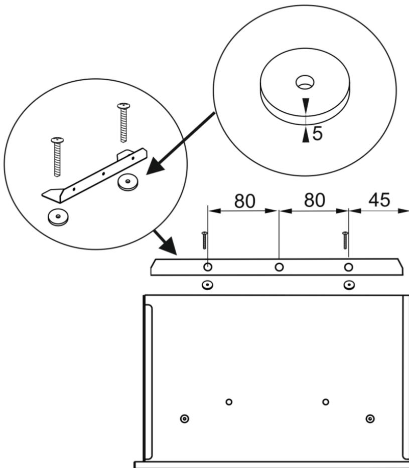
**PL:** Wskazane na rysunku podkładki służą do ewentualnego korygowania zabudowy okapu w meblu kuchennym. Jeśli po zamontowaniu okapu do bocznych ścian mebla, wskutek ewentualnych, nieznacznych niedokładności montażowych okaże się, że pomiędzy szybą okapu a meblem utworzy się niewielka szczelina, zdejmując wyżej opisane podkładki i ponownie dociągając śruby, można tę szczelinę skorygować.
